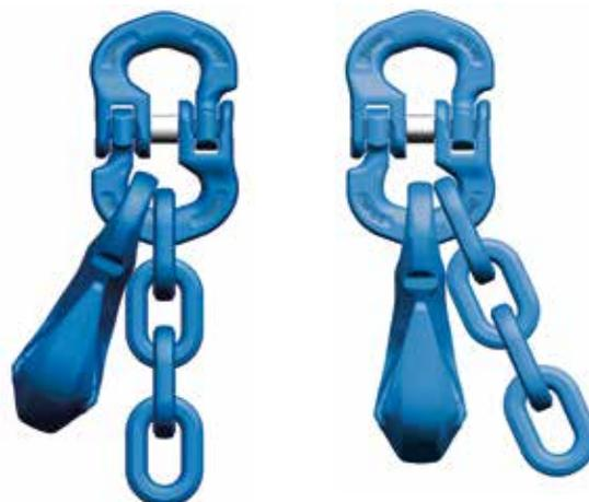
Das Verbindungsglied ist weit genug, um Verkürzer und Kette aufzunehmen. Das belastete Teil (Kette oder Haken) kann sich mittig positionieren und die symmetrische Belastung des Verbindungsgliedes ist gegeben.
